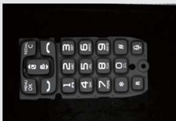
遥控按键印刷字符缺陷检测
